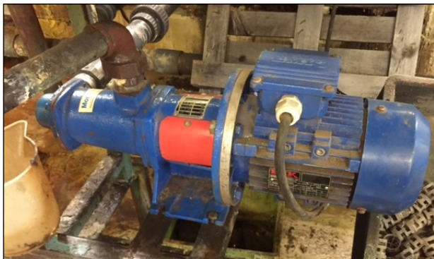
CGH233 : transfert huile de coupe 0,55kW - 960rpm
