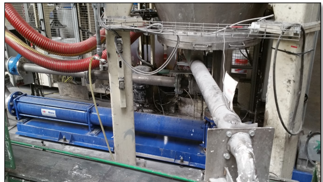
E19B : émulsion colle carrelage 17m 3 h - 3 bars
